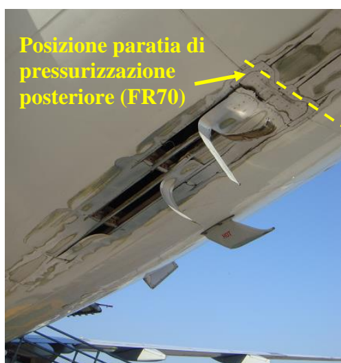
Foto 1: danneggiamenti principali alla fusoliera nella zona inferiore della coda.
