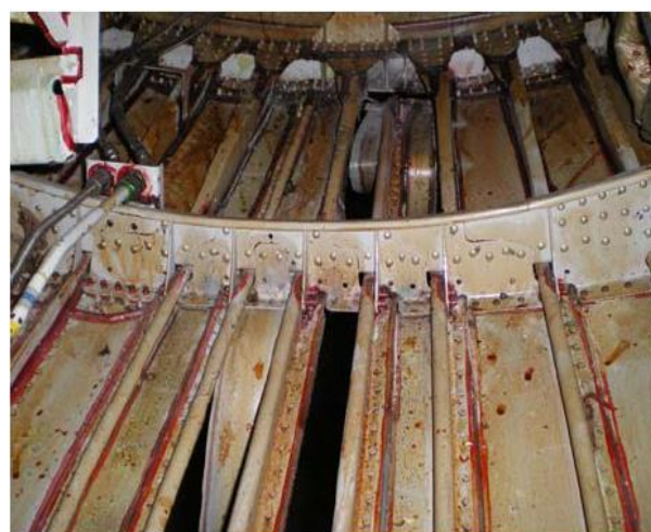
Foto 2: danneggiamenti visti dall'interno dell'aeromobile.
